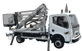
PEMP dont la translation n'est admise qu'avec la plate-forme de travail en position de transport avec élévation multidirectionnelle.
