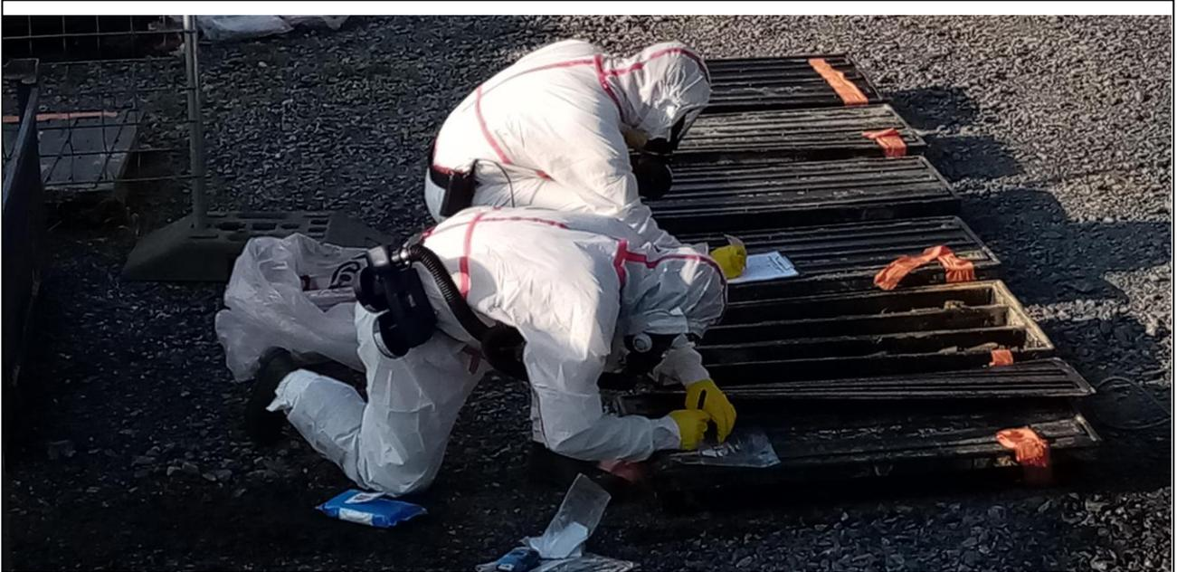
Figure 5: opération de prélèvement d'échantillons sur carottes lors d'une mission de repérage d'amiante environnemental. Source Cerema
