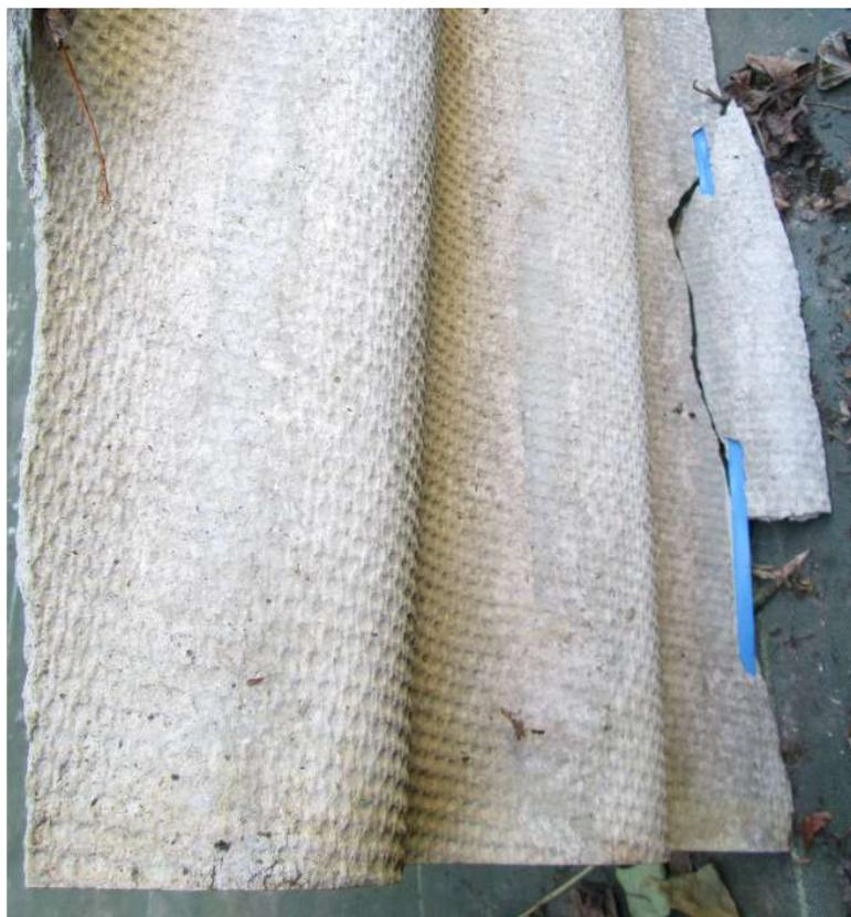
**Réponse** : les plaques peuvent être équipées de feuillards de renfort longitudinaux (couleur bleu), s'agissant d'un renfort (modification de la résistance) il est possible que cela ne s'applique pas uniquement aux plaques sans amiante
