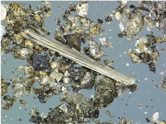
Abb. 3.6: Forsteritfaser aus den Drehofenversuchen mit Länge ca. 1.1 mm.
