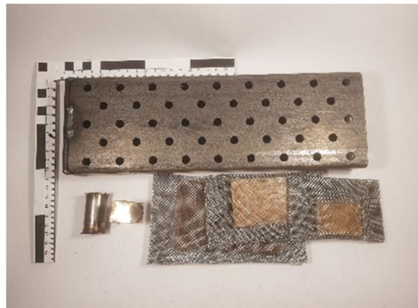
Abb. 4.1: Stahlkäfige mit asbesthaltigem CV-Belag für die Feldversuche.
