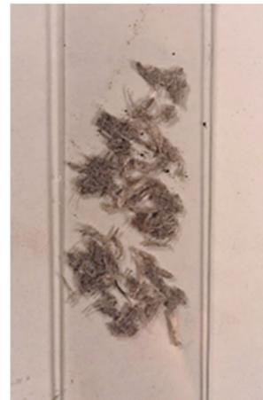
Abb. 3.2: (links): Für 60 min bei 800°C thermisch behandelter asbesthaltiger CV-Belag.
