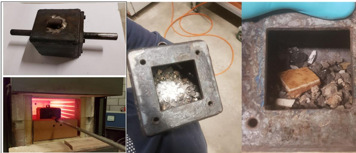
**Abb. 3.5:** *Der Labor-Drehofen am UMTEC. Der Stahlbehälter kann im Muffelofen von aussen rotiert und durch die Lanze belüftet werden. Mitte: Stahlbehälter gefüllt mit Schlacke und Chrysotil-Dichtschnur. Rechts: Stahlbehälter gefüllt mit Schlacke und CV-Boden.*
