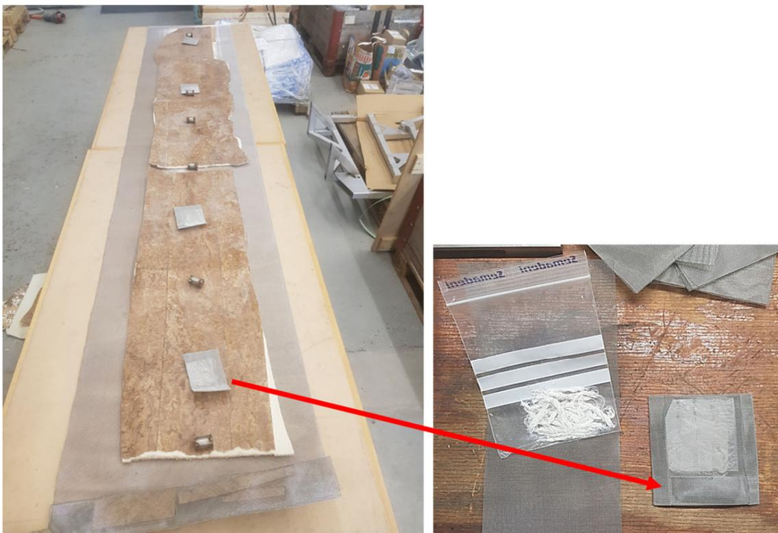
Abb. 4.7: Laminatboden mit "Chrysotilschnur-Briefchen" in Drahtgitter, Temperaturindikatorhülsen und Kern aus asbesthaltigem CV-Boden.
