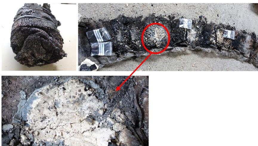
Abb. 4.14: Oben links: Roulade nach der Verbrennung, oben rechts: ausgerollte Roulade, unten: unverbrannter Laminatboden.
