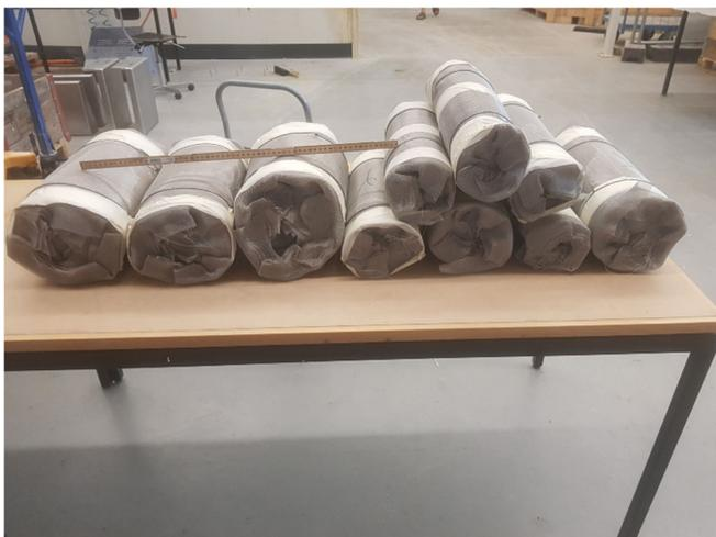
Abb. 4.8: Fertig gerollte Asbestrouladen.
