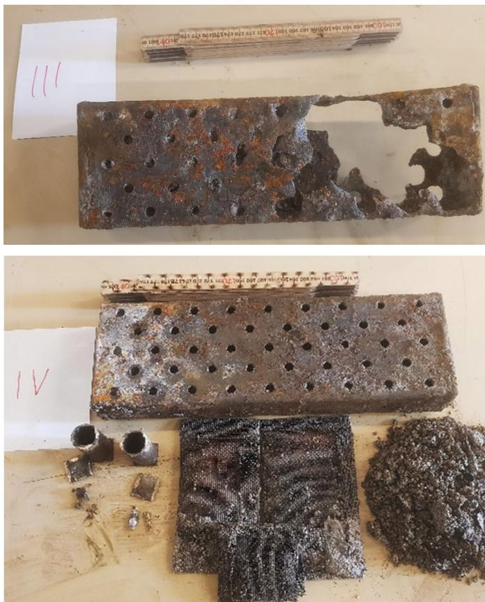
Abb. 4.3: Oben: durchgeschmolzener Behälter / unten: unversehrter Behälter mit Inhalt.
