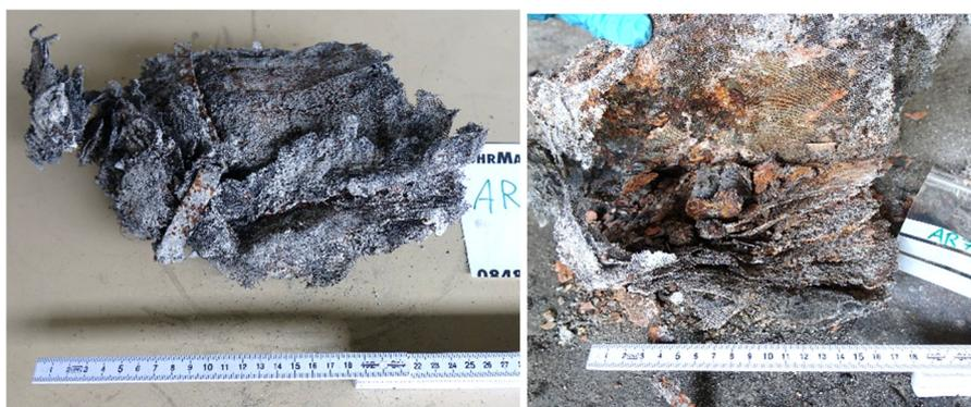
Abb. 4.15: Links: Roulade AR6 ohne Spritzasbest nach der Verbrennung, rechts: Kernansicht mit Indikatorhülsen
