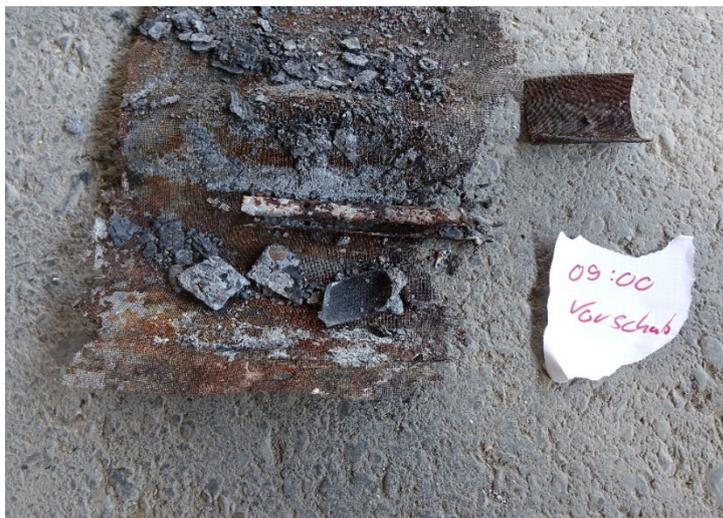
*Abb. 4.10: Thermisch behandelter asbesthaltiger CV-Boden aus dem Kern von Roulade R1 aus dem Vorschubrost.*
