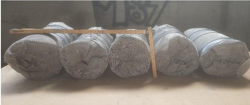
Abb. 4.12: Fertiggestellte Asbestrouladen mit Spritzasbest (Durchmesser. 15-20 cm, Länge: 35-40 cm).
