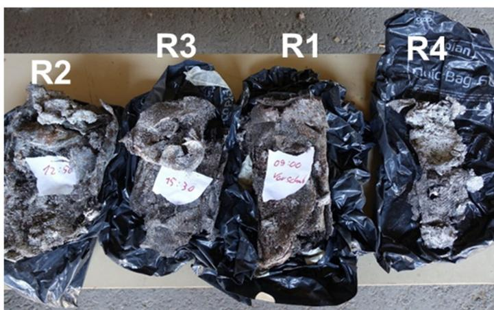
Abb. 4.9: Verbrannte Asbestrouladen aus dem Feldversuch 3 in der KVA Linth.
