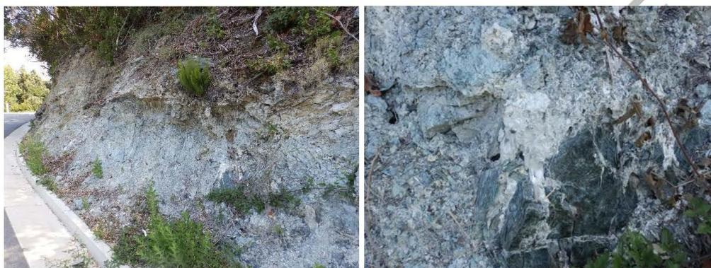
Figure 10 : Talus de la D 180 entaillant des serpentinites très amiantifères (site 2BDL0174).
