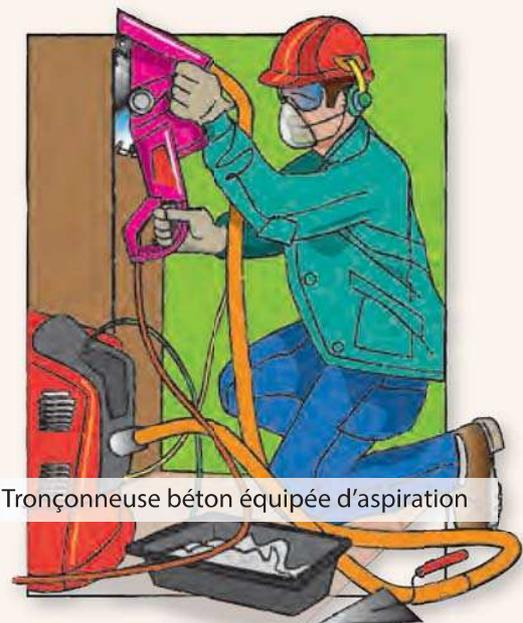
Et / ou s'assurer que le travail à l'humide est possible en utilisant des outils avec apport d'eau afin de réduire le niveau d'empoussièremement pour les travaux suivants :
