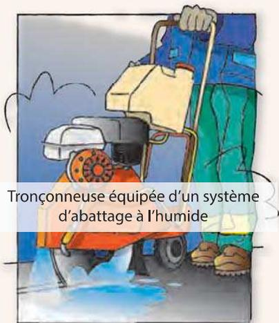
Tronçonneuse équipée d'un système d'abattage à l'humide
