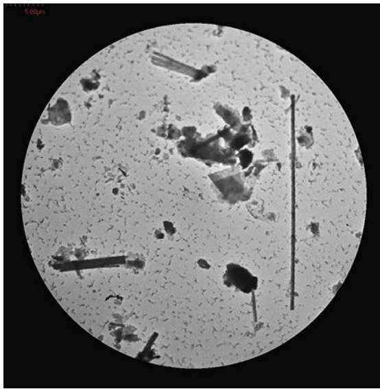
↑ FIGURE 2 Fibre d'anthophyllite-amiante observable au META (grossissement MET : x 3 000).
