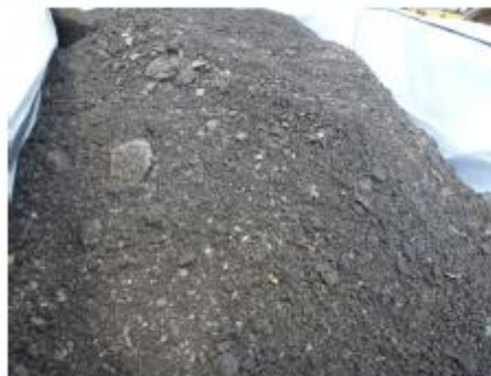
Lest fraisât d'enrobé routier.
